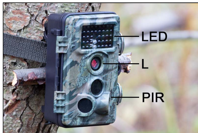
รูปที่ 2.6 เครื่องตรวจจับความเคลื่อนไหว PIR ใช้สำหรับควบคุมไฟภายนอกอาคารแบบอัตโนมัติ
