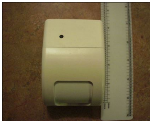
รูปที่ 2.13 PID ทั่วไปสำหรับที่พักอาศัย/เชิงพาณิชย์ ใช้กระจกแบ่งส่วนภายในเพื่อการโฟกัส
