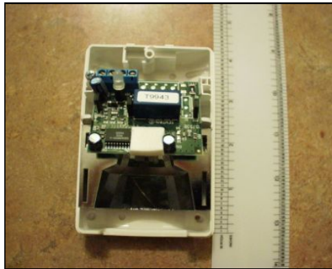
รูปที่ 2.14 ถอดฝาครอบออกแล้ว กระจกแบ่งส่วน ด้านล่างมีแผงวงจรพิมพ์ (PC) อยู่ด้านบน
