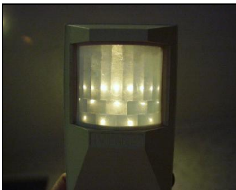
รูปที่ 2.11 ฝาครอบด้านหน้า PIR เท่านั้น (ถอดอุปกรณ์อิเล็กทรอนิกส์ออก) โดยมีแหล่งกำเนิดแสงจุดอยู่ด้านหลัง เพื่อแสดงเลนส์แต่ละตัว
