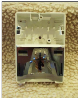
รูปที่ 2.15 แผงวงจรพิมพ์ถูกถอดออกเพื่อแสดงตรวจจับแบบแบ่งส่วน
