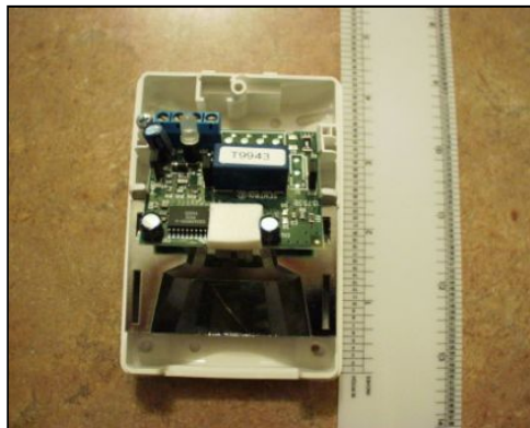
รูปที่ 2.14 ถอดฝาครอบออกแล้ว ตรวจจับแบ่งส่วน ด้านล่างมีแผงวงจรพิมพ์ (PC) อยู่ด้านบน
