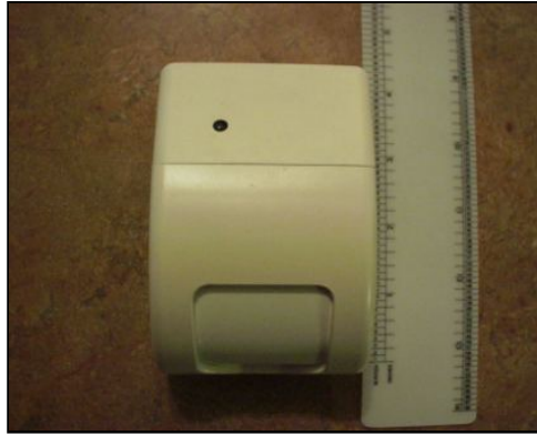
รูปที่ 2.13 PID ทัวไปสำหรับที่พักอาศัย/เชิงพาณิชย์ที่ ใช้ตรวจจับแบ่งส่วนภายในเพื่อการโฟกัส
