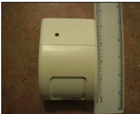
รูปที่ 2.13 PID ทัวไปสำหรับที่พักอาศัย/เชิงพาณิชย์ที่ใช้กระจกแบ่งส่วนภายในเพื่อการโฟกัส
