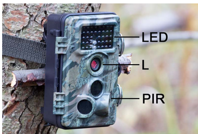
รูปที่ 2.7 กล้องถ่ายภาพพร้อมระบบตรวจจับความเคลื่อนไหวแบบ PIR
