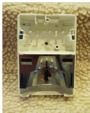
รูปที่ 2.15 แผงวงจรพิมพ์ถูกถอดออกเพื่อแสดงกระจกแบบแบ่งส่วน
