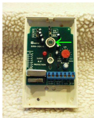
รูปที่ 2.12 PIR ที่ถอดฝาครอบด้านหน้าออก แสดงตำแหน่งของ เซ็นเซอร์ไพโรอิเล็กทริก (ลูกศรสีเขียว)
