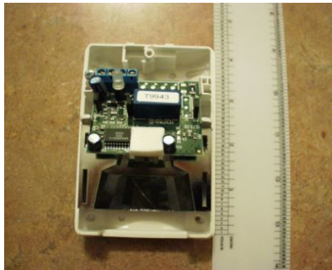
รูปที่ 2.13 ถอดฝาครอบออกแล้ว กระจกแบ่งส่วน ด้านล่างมีแผงวงจรพิมพ์ (PC) อยู่ด้านบน
