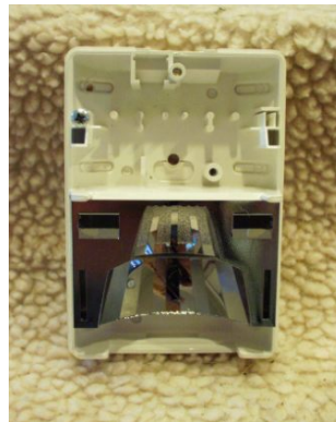
รูปที่ 2.14 แผงวงจรพิมพ์ถูกถอดออกเพื่อแสดงกระจกแบบแบ่งส่วน
