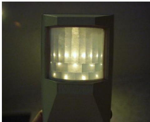
รูปที่ 2.10 ฝาครอบด้านหน้า PIR เท่านั้น (ถอดอุปกรณ์อิเล็กทรอนิกส์ออก) โดยมีแหล่งกำเนิดแสงจุดอยู่ด้านหลัง เพื่อแสดงเลนส์แต่ละตัว
