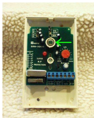
รูปที่ 2.11 PIR ที่ถอดฝาครอบด้านหน้าออก แสดงตำแหน่งของ เซ็นเซอร์ไพโรอิเล็กทริก (ลูกศรสีแดง)
