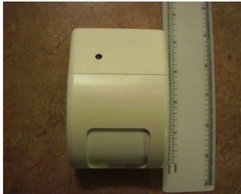
รูปที่ 2.12 PID หัวไปสำหรับที่พักอาศัย/เชิงพาณิชย์ที่ใช้กระจกแบ่งส่วนภายในเพื่อการโฟกัส
